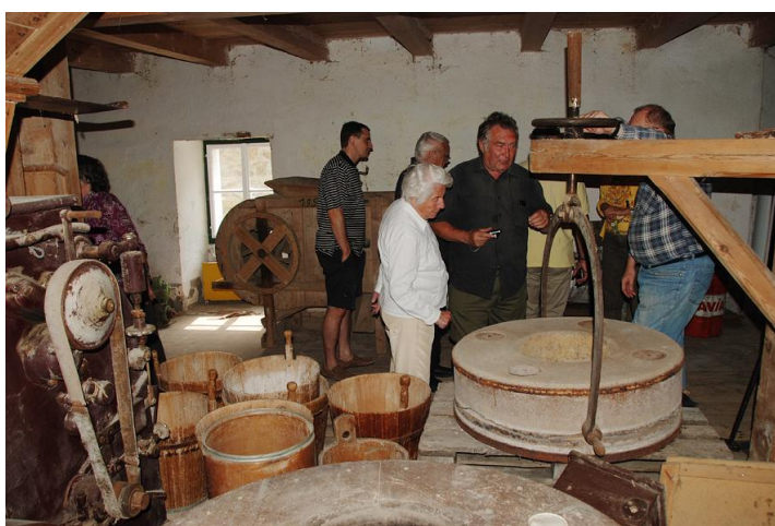
Zur Restaurierung ausgebauter Mühlstein. Die dünnwandigen Schaffeln mit einem Handgriff erinnern an das händische Befördern des Mahlgutes. Im Hintergrund die Getreidewinde (Tarar). Von den Arbeitsgeräten des Müllers sind noch Metzenschaffeln mit eingebraunten Eichzeichen vorhanden.
