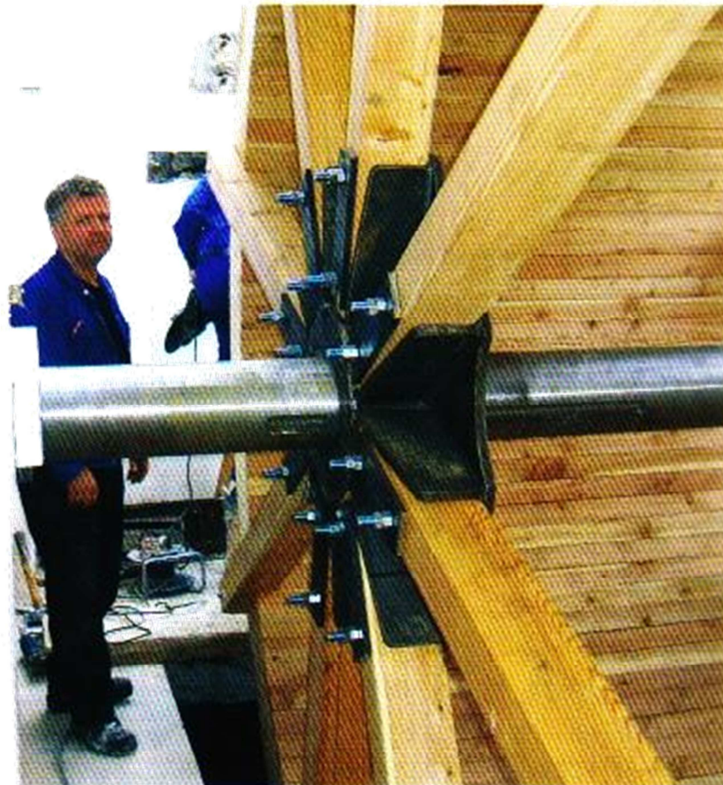
Abb. 2: Der Wellenanschluss des Wasserrades am Stift St. Peter
